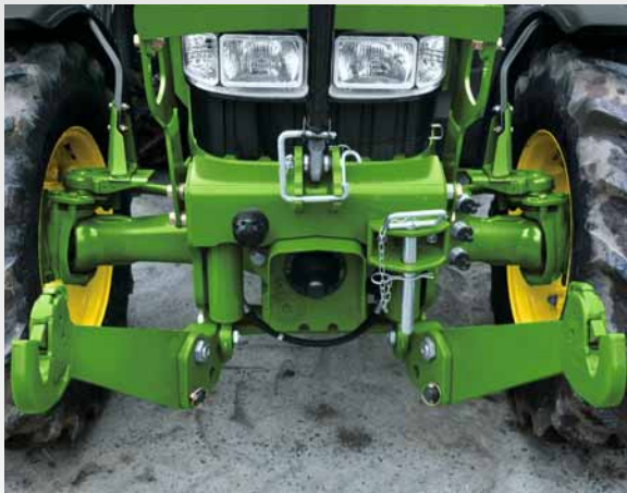
Das vollintegrierte Fronthubwerk und die Frontzapfwelle sind ideal für Frontmäher geeignet.
